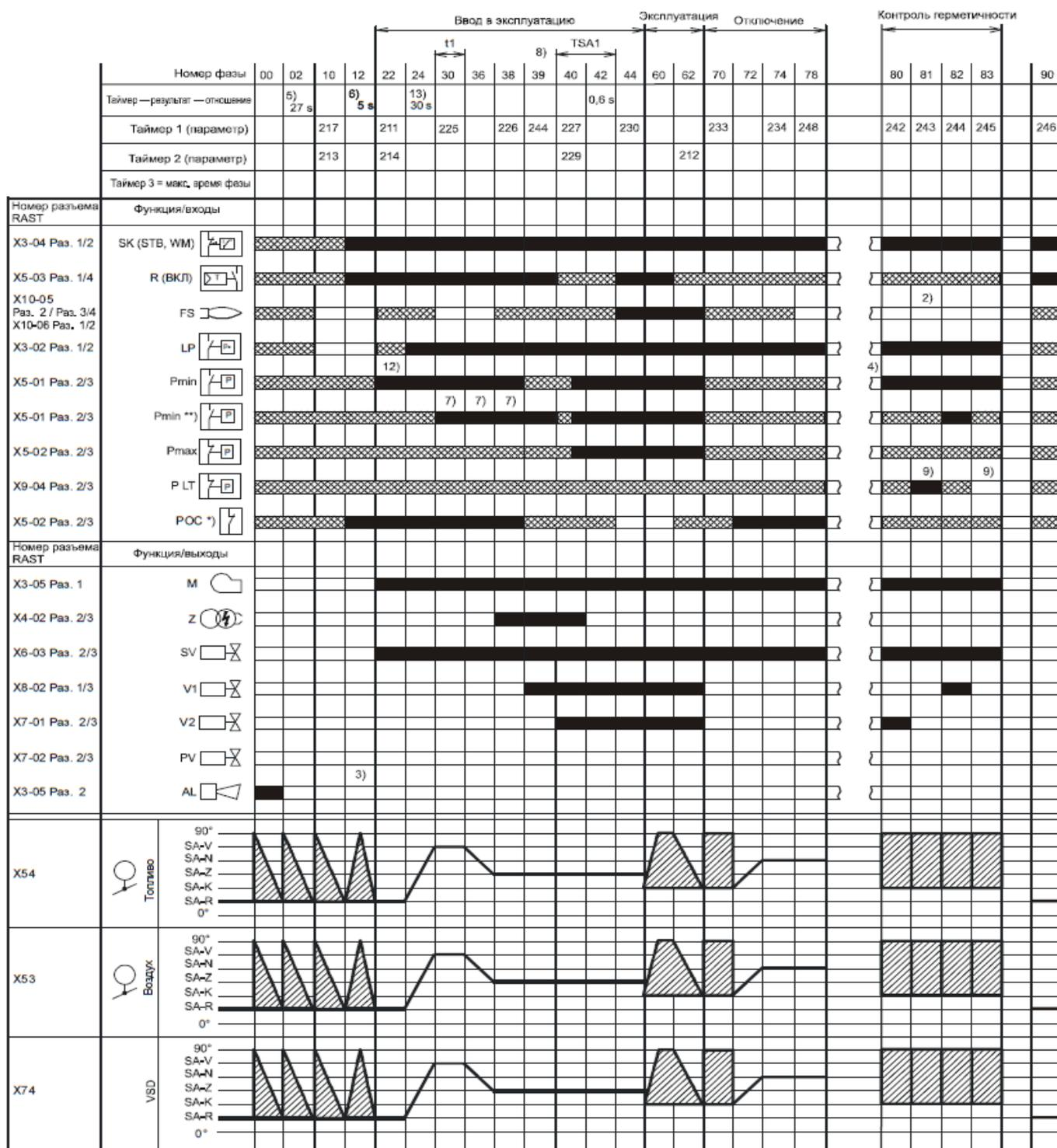
Контроль герметичности осуществляется в соответствии с параметром: параллельно со временем предпродувки и/или параллельно со временем догорания.
