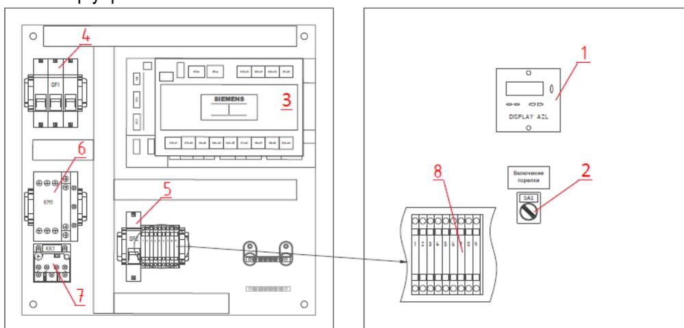
Рис.5. Внешний и внутренний вид шкафа управления горелкой T-2.135 G.E
