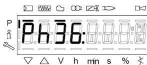
Фаза перехода исполнительных механизмов (сервопривода воздушной и газовой заслонок) в положение зажигания (точка P0).
