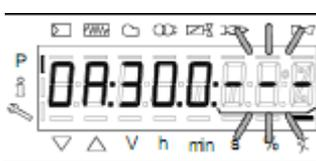
При одновременном нажатии кнопок «A» и «-» или «+» можно установить положение воздушной заслонки в точке розжига P0. Например 22,0
