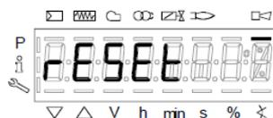
На дисплее отобразится надпись «reset». После отпускания клавиши основное устройство разблокировано.
