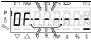
При одновременном нажатии кнопок «F» и «-» или «+» можно установить положение газовой заслонки в точке розжига P0. Например 30,0
