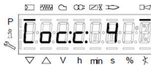
Ошибка с блокировкой (неисправность). Горелка находится в заблокированном режиме. Актуальный код ошибки «c» отображается попеременно с диагностическим кодом «d».
