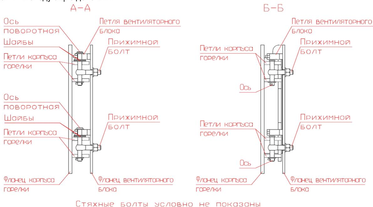
Рис.8 Поворотный фланец (А-А, Б-Б)
