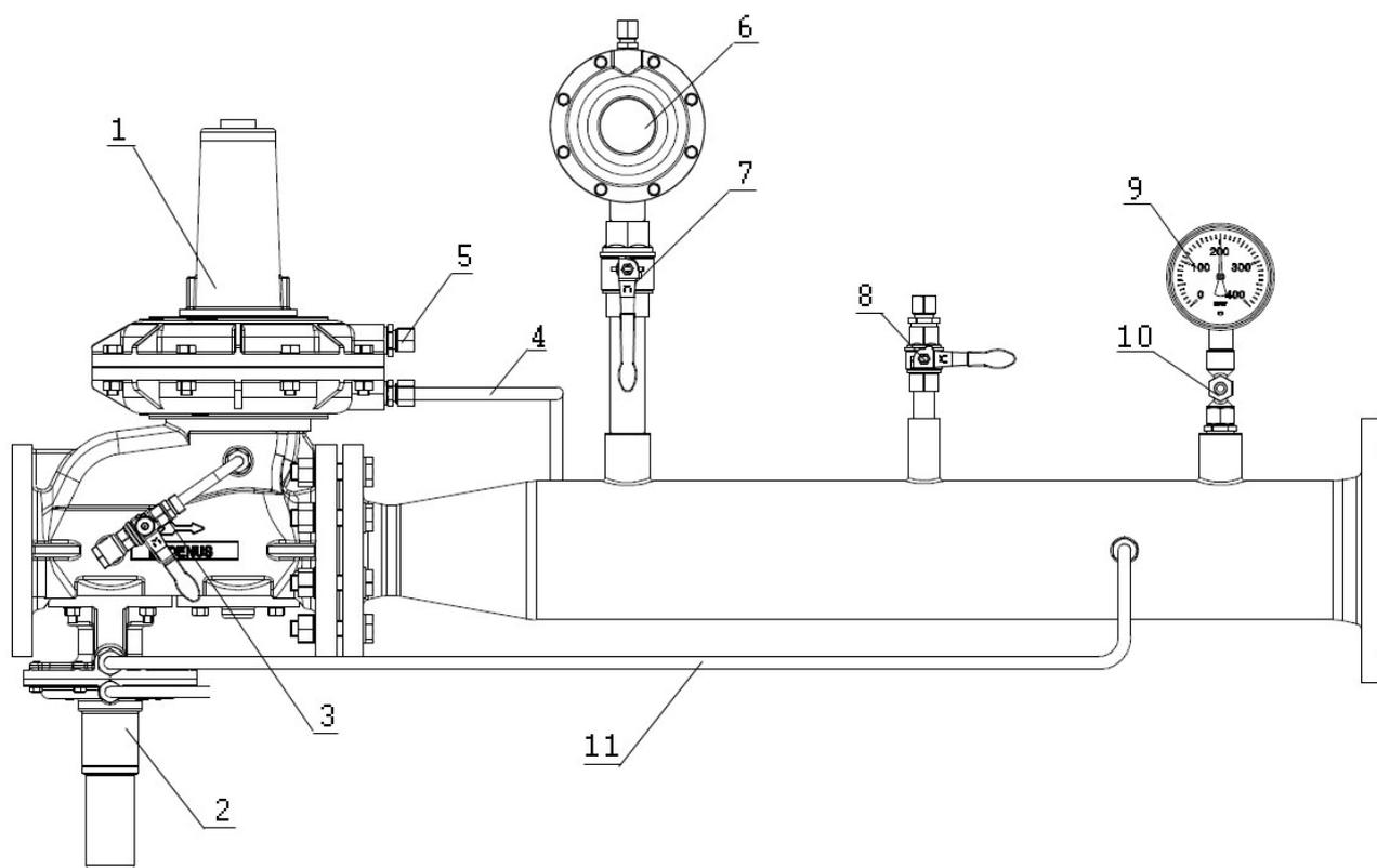
Рис.3. Общий вид линии понижения давления газа.
