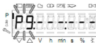
Нажать «+» для перехода к следующему параметру P9 – точка номинальной мощности.
