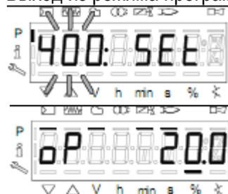
Одновременным нажатием кнопок «-» и «+» выйти из меню настройки нижнего предела мощности горелки.
