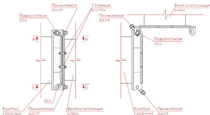
Для поворота вентиляторного блока необходимо извлечь стяжные болты, ослабить прижимные болты поворотных осей и отвести в сторону прижимные болты осей и, при необходимости отключить, мешающие повороту электрические кабели.
