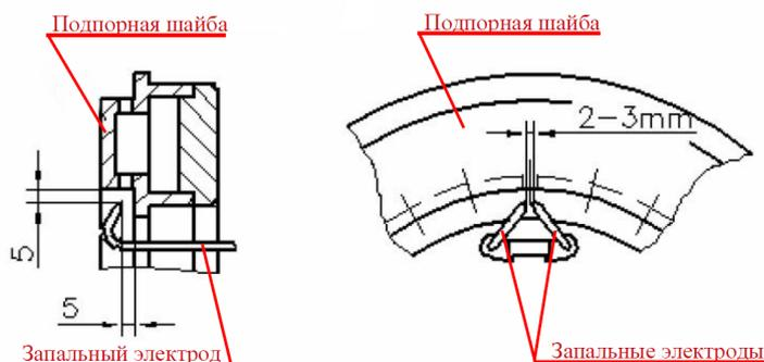
В горелке Т-2.135 G применяется прямой розжиг горелки без применения запального устройства. Запальные электроды крепятся на кронштейне, позволяющем изменять их положение относительно подпорной шайбы.
