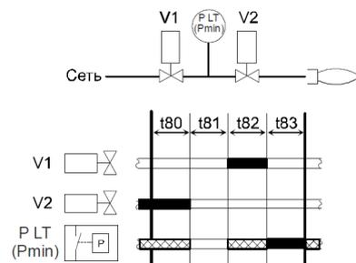
Рис.14 Контроль герметичности
