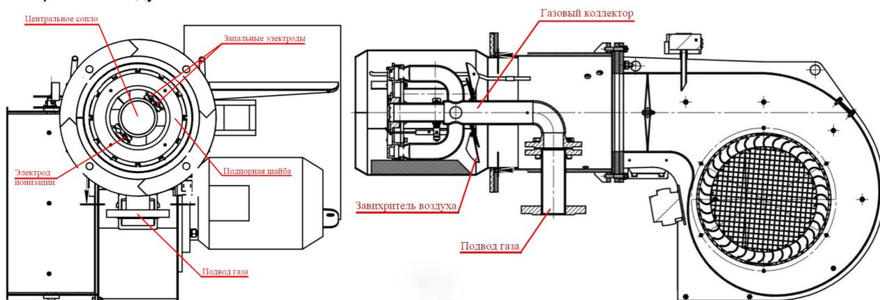
Рис.10 Внутренняя газовая линия горелки Т-2.135 G
