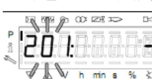
Нажать кнопку «i/reset», на дисплее появится параметр «201» - режим работы горелки «топливная рампа».
