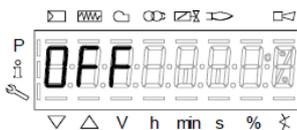
Горелка находится в технологическом останове (нет запроса на тепло) или переключатель «Пуск/Стоп» в положение «Стоп».
