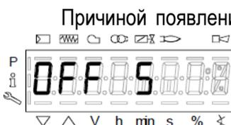
Причиной появления сигнала о неисправности «**контур безопасности разомкнут**» является размыкание внешней цепи безопасности, например, от шкафа котловой автоматики (по температуре, давлению, уровню и др.). Персоналу необходимо устранить неисправности во внешней цепи безопасности.
